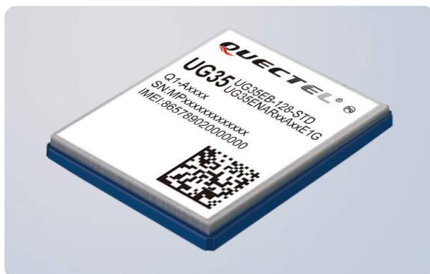
UG35 模块是一款高性价比的多频段 UMTS/HSPA 解决方案，支持下行速率 7.2Mbps 和上行速率 5.76Mbps。在尺寸上完全兼容移远通信 GSM/GPRS M35 模块，同时满足 GSM/UMTS 两种网络制式的需求，使产品由 2G 向 3G 的平滑过渡变得轻松、可行。
